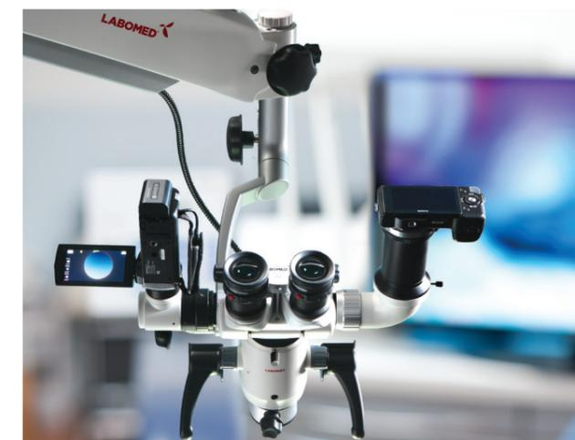
En cuanto a la obtención de datos digitales, la gama *ProLine* pone a su disposición multitud de adaptadores para SLR digitales, videocámaras y CCD, además de iVu, la solución multifuncional de obtención de imágenes patentada por LABOMED.
