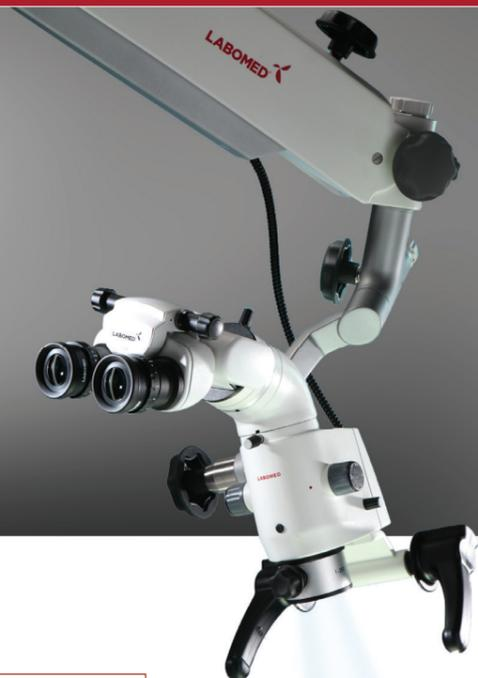
El objetivo variable *NuVar™* permite al dentista seleccionar la distancia de trabajo ideal en función de los requisitos que exija cada procedimiento. *NuVar™* ofrece un ajuste fluido de la distancia focal de 300 mm a 400 mm.
