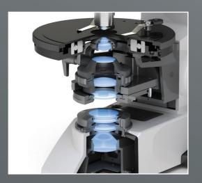
Para las imágenes conoscópicas precisas, dispone de un módulo integrado con lente Bertrand enfocable entre los tubos de observación y la muestra. El centrado de la lente Bertrand se logra por medio de tornillos de centrado de fácil acceso. Dentro del módulo del analizador se han dispuesto unas ranuras para guardar las llaves tipo Allen que permiten centrar el analizador y los objetivos.
